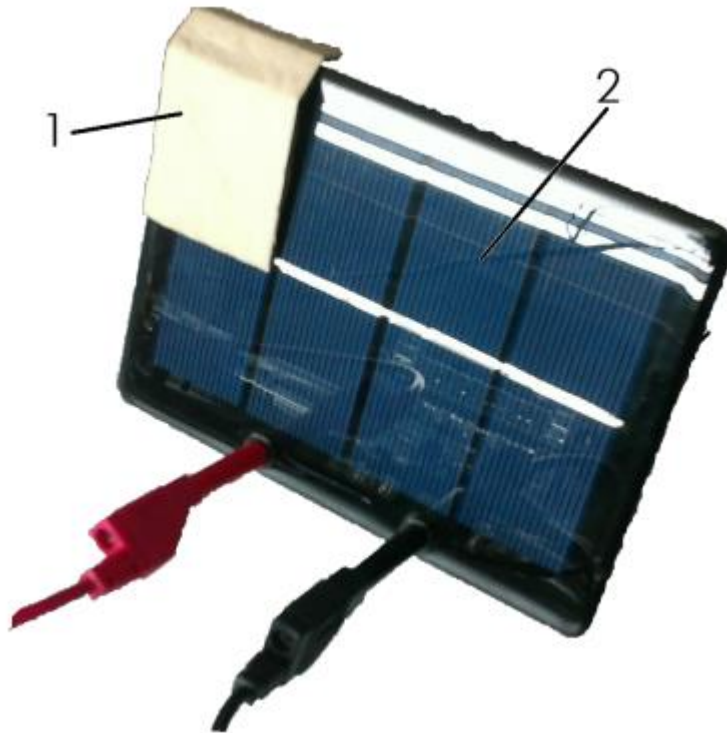
Slika 10: Pola solarne ćelije solarnog panela (2) je zasenčeno uz pomoć kartona (1)
