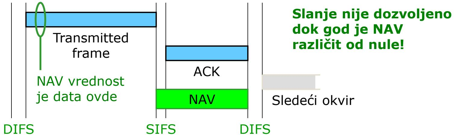
Virtual carrier sensing označava da je **NAV vrednost** postavljena u svim stanicama a koju je moguće očitati iz okvira koji je u prenosu.
