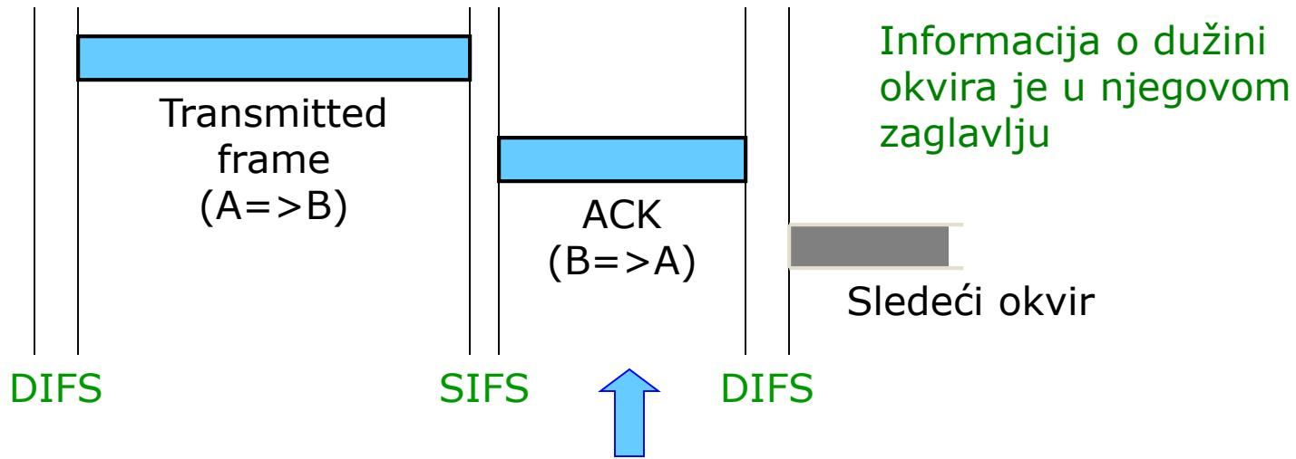
**Physical carrier sensing** – fizički sloj (PHY) informiše MAC pod-sloj kada se u kanalu detektuje okvir. Prioriteti u pristupu medijumu se rešavaju kroz dužinu intervala između okvira.
