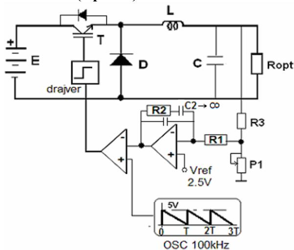
Za DC-DC pretvarač na slici su dati :  $E = 220VDC$ ,  $R_1 = 100k$ ,  $R_2 = 220k$ ,  $C_2 \rightarrow \infty$ ,  $R_3 = 10k$ ,  $R_{opt} = 50\Omega$ ,  $L = 400\mu H$ ,  $C \rightarrow \infty$ . Dioda i prekidački transistor su idealni. Vrednost potencijometra  $P_1$  iznosi  $500\Omega$ .
