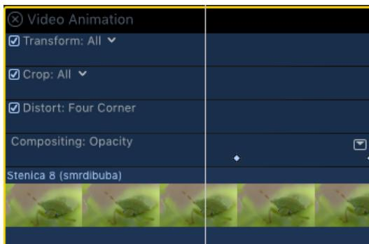
U zavisnosti od broja uključenih opcija u prozoru Inspector, iznad klipa će se pojaviti više traka za prikaz animacije ključnih slika.
