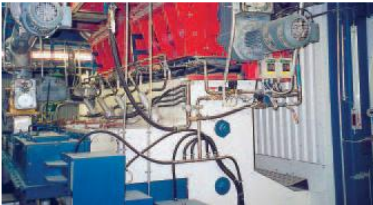
Izgled NID miksera i hidratora sa recirkulacionim rotacionim dodavačem (feeder-om)- ALSTOM proizvodnje
