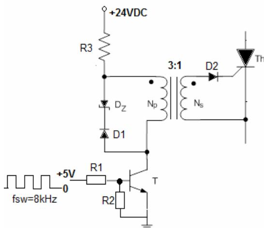
(3) Dimenzionisati pobudno kolo tiristora prikazano na slici ( $R_1, R_2, R_3, V_z$ ), uz pretpostavku da je u kolu gejta svakog od tiristora potrebno ostvariti struju gejta od 1A i napon gejt-katoda od 5V.
