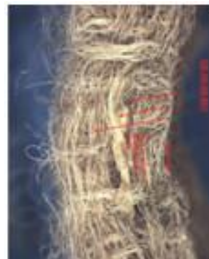
Poprečni presek zaprljanog filtera
