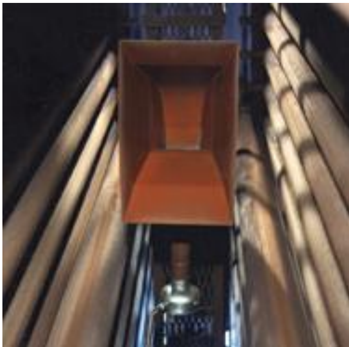
Akustički pobuđivač u vrećastom filteru
