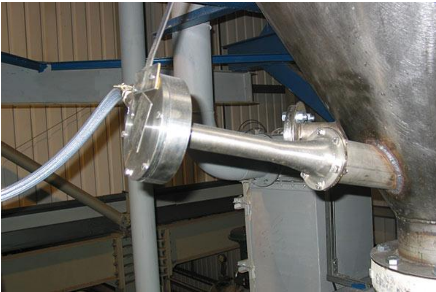
Način montaže akustičkog čistača prihvatnih levkova
