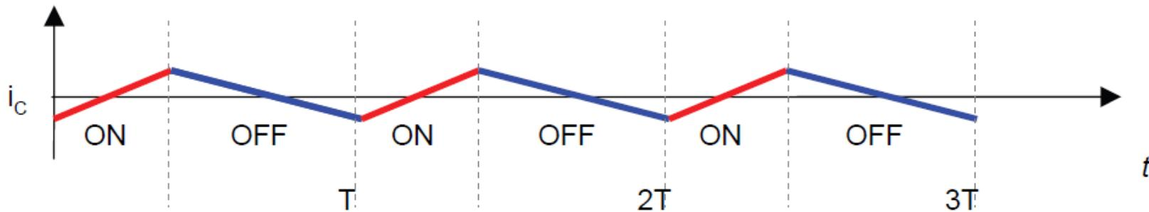
Kroz kondenzator protiče AC(naizmenična) komponenta struje prigušnice
