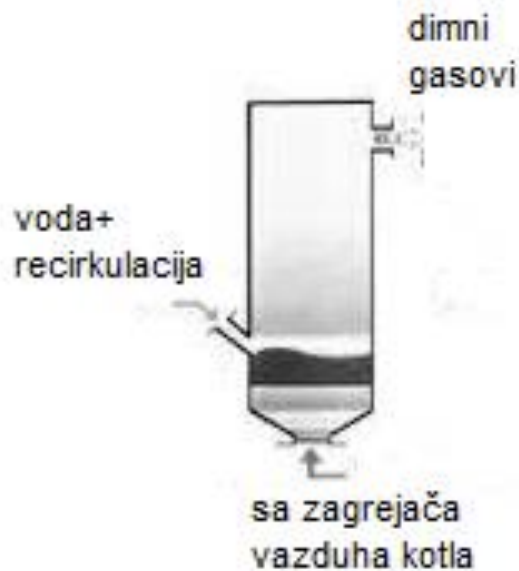
Reaktor sa nepokretnim slojem
