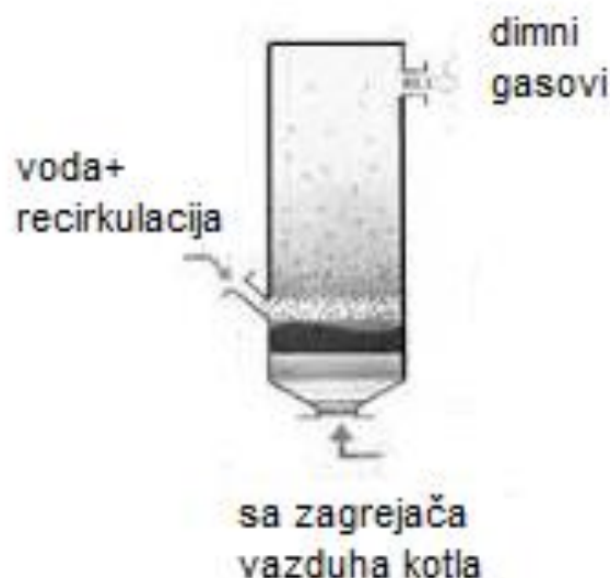
Reaktor sa mehurastim fluidizovanim slojem
