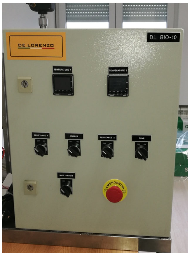
Slika 2: Komandna tabla laboratorijske opreme za proizvodnju biodizela
