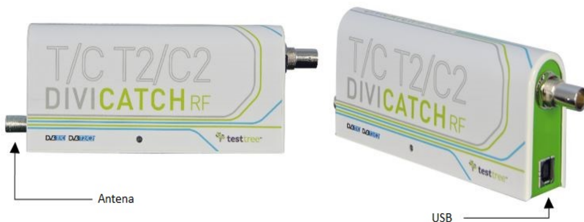
Slika 3. Povezivanje antene i analizatora DiviCatch RF T/C T2/C2
